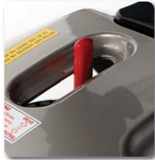
Einfacher Wechsel zwischen "Fahren" und "Freilauf"
