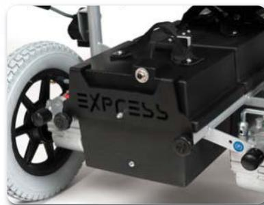
Einfacher Zugang zum Entkoppeln des Motors und zum Herausnehmen der Batterie
