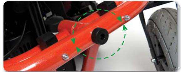
Die Pendelachse sichert einen permanenten Bodenkontakt auch im unwegsamem Gelände.
