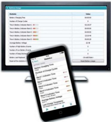
Die **LiNX**-Schnittstelle ist auf iOS und PC verfügbar, sodass Sie einen Stuhl schnell und einfach konfigurieren oder seine Daten analysieren können
