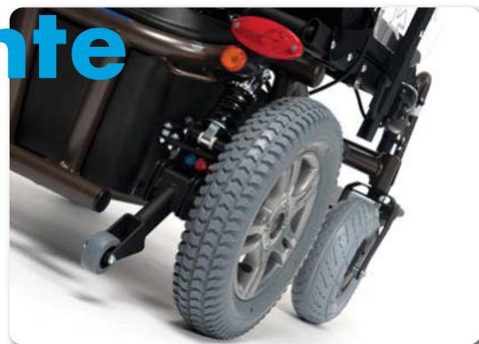
Rückleuchten, Reflektoren und Blinker hinten
