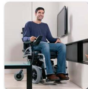
Gegenläufige Drehbewegung der Antriebsräder vorne ermöglicht das Wenden mit geringem Wendekreis.
