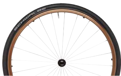
Beispiel: 24" Leichtlaufad mit Hohlkammerfelge, radial gespeicht
