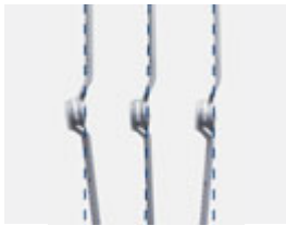
monozentrisches Gelenk für Abduktion / Adduktion und Flexion / Extension
